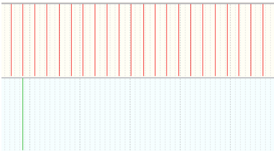
Wygląd nieprawidłowego przebiegu sygnału z wieńca wałka rozrządu.
