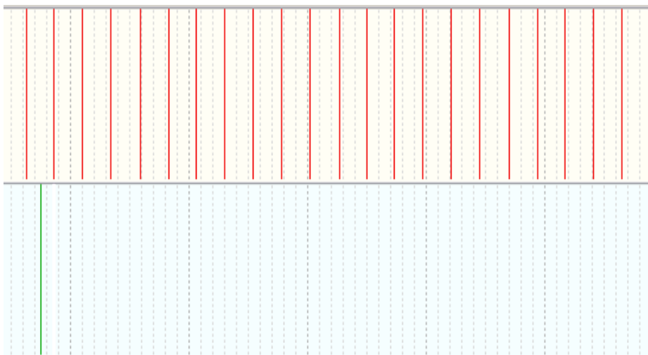
Wygląd prawidłowego przebiegu sygnału z wieńca wałka rozrządu
